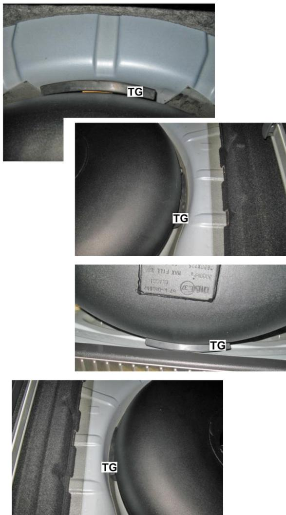
Dettaglio del posizionamento dei tamponi in gomma "TG" in sequenza: anteriore, lato destro, posteriore e lato sinistro.
