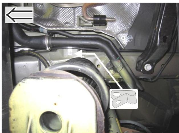
Il tubo alta pressione Ø 6 mm passa sopra al tubo rabbocco benzina ed è fissato al longherone a lato della molla ammortizzatore con una fascetta metallica.
