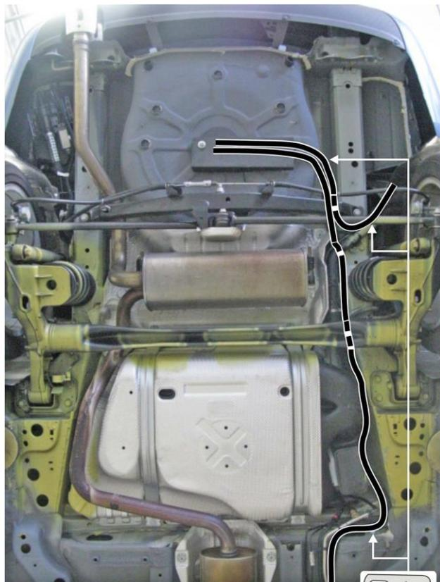
Fissare i tubi alta pressione ad intervalli regolari.
