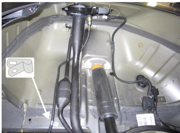
Fissare il tubo alta pressione Ø 8 mm con una fascetta metallica al longherone.
