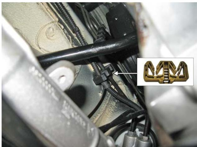
Dettaglio posizionamento del supporto tubi a due vie, sul secondo perno filettato originale, in prossimità del servofreno. Agganciare il tubo gas alta pressione ed il corrugato multi-valvola.
